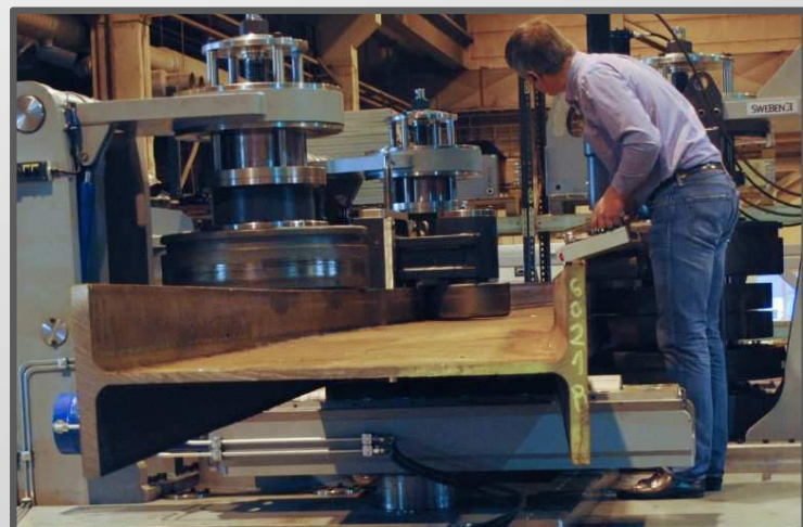
Sur les modèles SB3S-XXX, il est possible d'avoir les rouleaux de guidage réglables dans le plan (réglage de la longueur)
