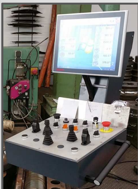
En option, nous proposons d'avoir le panneau de commande (ici TFT 15") sur un bras oscillant. Il est également possible de régler l'angle d'inclinaison de l'écran.
