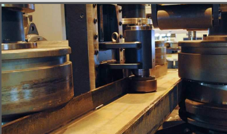
UPE400 ("C15x50") roulant à l'aide d'une tête de traction standard et de rouleaux universels
