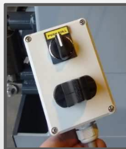
Commande avec joystick pour rotation et commutateur pour pousser le rouleau.
