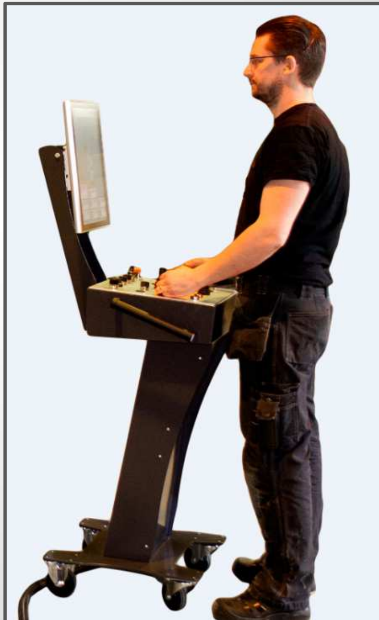
Notre propre panneau de commande (ici un 19" TFT) sur les roues est léger et facile à déplacer. Notez que l'écran peut être incliné pour correspondre à la hauteur des opérateurs.
