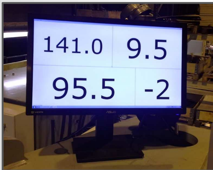
Possibilité d'utiliser un écran TFT standard pour afficher les positions d'axe en grand format qui peuvent être vus à distance si la machine est utilisée par notre unité de commande sans fil.
